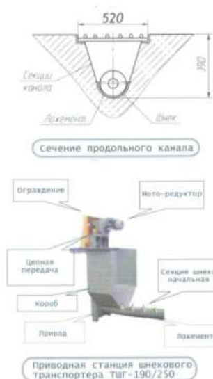
Поперечный транспортер ТШГ-250
